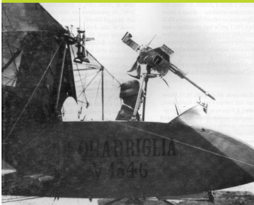
UN VELIVOLO VOISIN DELLA 5ª SQUADRIGLIA ARMATO CON UNA MITRAGLIATRICE FIAT-REVELLINI MOD. 1914 SULLO SPECIALE AFFUSTO STUDIATO PER QUESTO TIPO DI MACCHINA ALLO SCOPO DI MASSIMIZZARE IL CAMPO DI TIRO E CON UNA PISTOLA-MITRAGLIATRICE VILLAR PEROSA CALIBRO 9 MM A DUE CANNE PER LA DIFESA DEI QUADRANTI POSTERIORI (AERONAUTICA MILITARE – UFFICIO STORICO)
