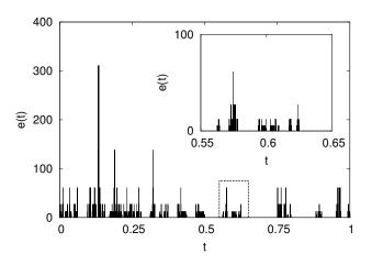
L'energia dissipata in fluido turbolento in funzione del tempo; notare come l'ingrandimento di una parte sia simile al tutto.
